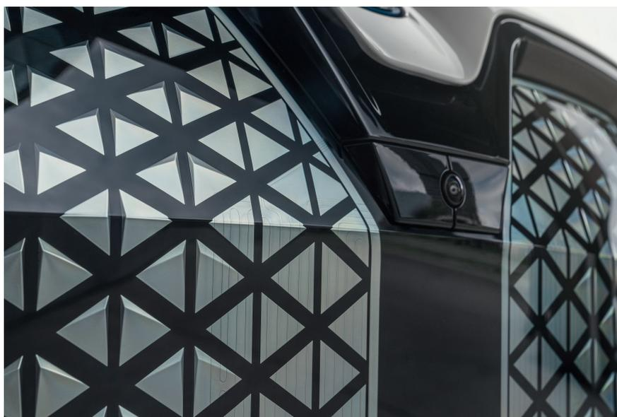
**Bild 1.** Gefertigt wird das markante Frontpanel des BMW iX aus dem PC Makrolon AG von Covestro. Kameratechnik, Radarfunktionen und weitere Sensorik für das Fahrerassistenzsystem sind in das großflächige Bauteil integriert. © BMW
